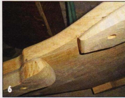
После этого подготовил и прикрепил опоры тумбы к нижней полке.
