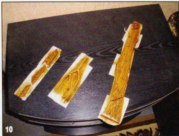
10 Перед приклеиванием декоративные элементы аппликации нужно окрасить. Чтобы защитить тыльную сторону при обработке морилкой, наклеил их на малярную ленту.
