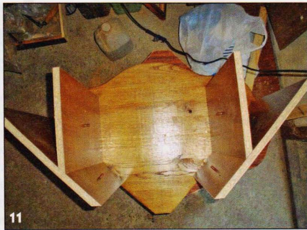
11 Составные боковые стенки тумбы (вид сверху). Тыльные кромки стенок спилены под углом 45°, и поэтому в местах соединения нет зазоров.
