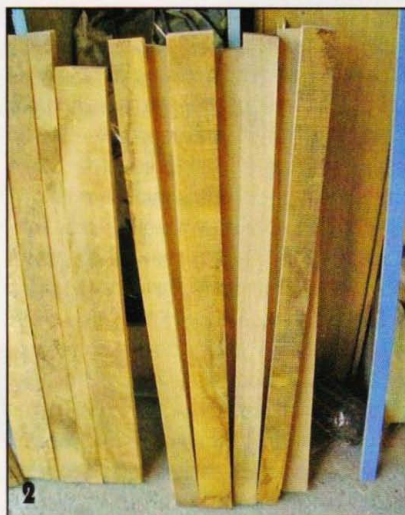
Тщательно прострогал кромки дубовых заготовок, чтобы потом склеить из них мебельные щиты.
