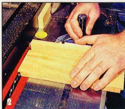
Шипы, образованные фальцами по торцам крышки и дна, входят в пазы боковых стенок.
