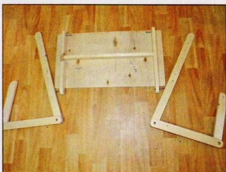
Шарнирные соединения и возможность варьировать длину задних ножек столика позволяют менять угол наклона столешницы в широком диапазоне.
