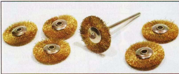
Латунными щётками Ø22 мм можно удалить налёт с поверхности детали или ржавчину (фото 8), почистить детали. Применяют их также для матирования и тонкого шлифования.
