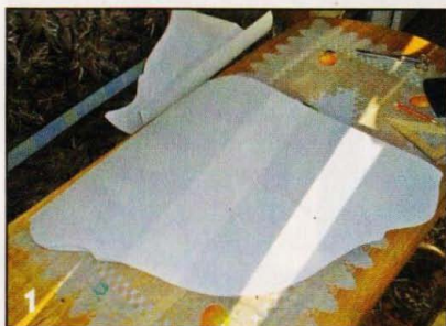
Из ватмана вырезал выкройку для шаблона, который пригодится при изготовлении основных полок.
