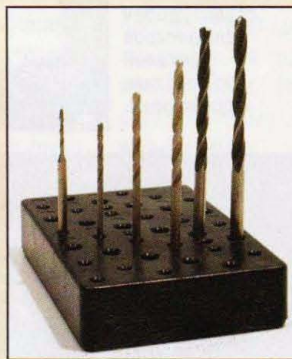
Алмазные свёрла (для стекла) диаметром 1,0; 1,2 и 1,4 мм.
