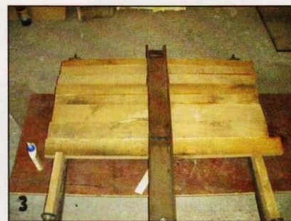
Заготовки сплачивал и склеивал в щит, используя самодельные ваймы.
